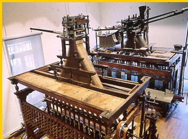
Métier à tisser les rubans avec mécanique Jacquard
