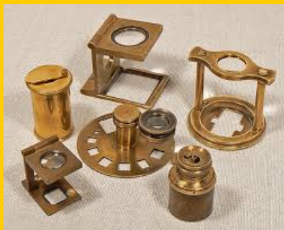
Les quarts de pouce servent à compter les fils et vérifier le tissage.
